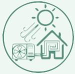
5 **Aeroterminia para generación de calor y ACS:** Un sistema de aeroterminia nos permite aprovechar la energía del aire para calentar el agua almacenada en un depósito aislado térmicamente y destinada a abastecer a las viviendas de agua caliente sanitaria. Además el mismo sistema, generará calor para calentar las viviendas, sin emisiones de CO2 y reduciendo el impacto ambiental, con un gran ahorro energético y económico.
